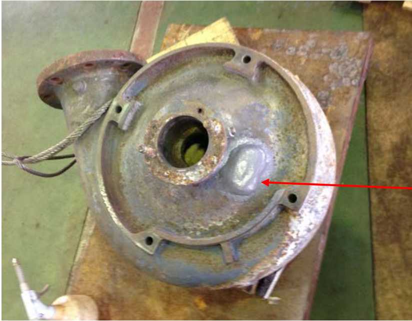
[写真-7] 耐摩耗パテ「HL-SPS」でケーシングの 開口部を肉盛り補修
